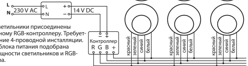
Схема 4. Светильники присоединены к центральному RGB-контроллеру. Требуется проведение 4-проводной инсталляции. Мощность блока питания подобрана к общей мощности светильников и RGB-контроллера.
