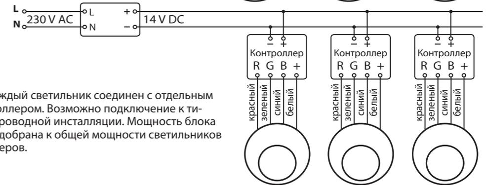
Схема 3. Каждый светильник соединен с отдельным RGB-контроллером. Возможно подключение к типичной 2-проводной инсталляции. Мощность блока питания подобрана к общей мощности светильников и контроллеров.
